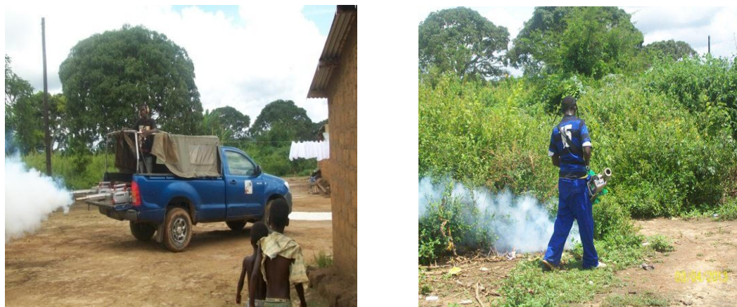
Figura 7. Aplicación de insecticidas adulticidas espacial con técnica de arrastre, LATIFA TF 95( izquierda) y termonebulización ,TF-35(derecha)
